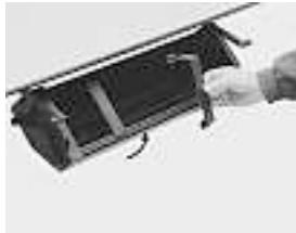
Si hubiera pinzas para cables para fijar los cables en la caja, éstas deben retirarse. Una vez realizada la modificación de la conexión la caja para cables puede volver a cerrarse. Recuerde volver a colocar las pinzas para cables en su lugar y a encajar los tiradores en los extremos.
